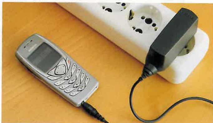
Ist der Spannungsumwandler in dem Stecker integriert, zieht er Strom aus dem Netz – hier ein Ladegerät für Handys
