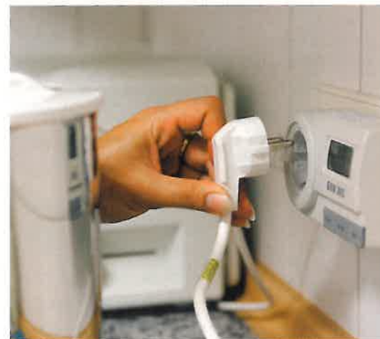
Das Strommessgerät zeigt den Verbrauch an
