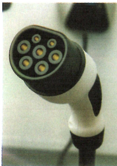
Der Typ-2-Stecker hat sich inzwischen bei vielen Herstellern durchgesetzt.
